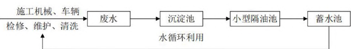
图 5-2 机修含油废水处理工艺流程图
